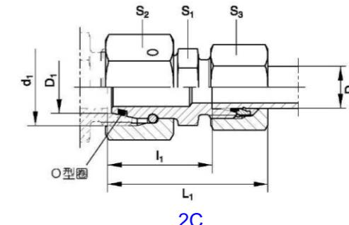
2C 对接式变径接头
