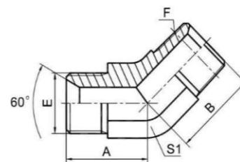
1BT4-SP 45°弯英管外螺纹 60°内锥/英锥管外螺纹
