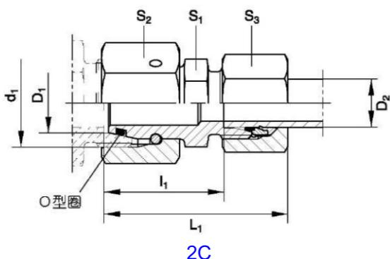
2C 对接式变径接头
