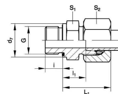
1CH-ED 直通接头-公制螺纹ED型弹性密封
