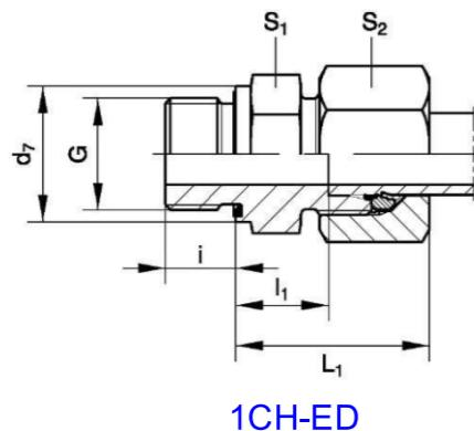
ICH-ED 直通接头-公制螺纹ED型弹性密封
