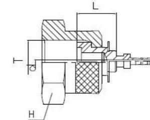
S202A1 公制内螺纹 平面带O型圈
