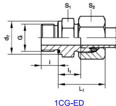
1CG-ED 直通接头-英制螺纹ED型弹性密封
