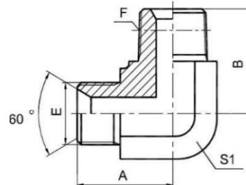
1BT9-SP 90°弯英管外螺纹 60°内锥 I 英锥管外螺纹
