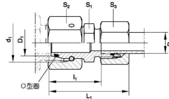
2C 对接式变径接头
