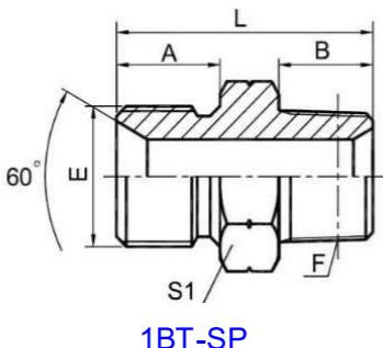
1BT-SP 英管外螺纹 60°内锥或六角端面用组合垫密封/英锥管外螺纹
