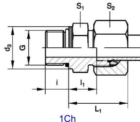
1Ch 直通接头-公制螺纹O型圈密封
