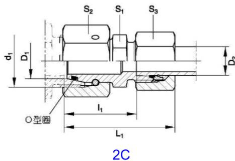
2C 对接式变径接头
